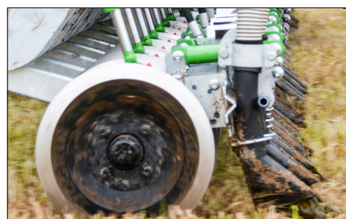
Nowa wersja umieszczenia węża w kołnierzu i nowe zaciski hydrauliczne
